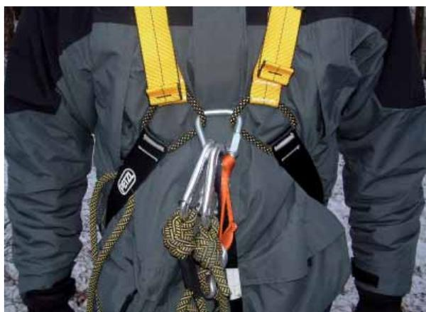
Abbildung 6: Auffanggurt als Teil eines Sicherungssystems
