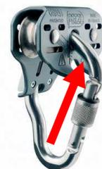
Der Teilnehmer wurde etwas „ruppig“ abgebremst, was ein Schaukeln zur Folge hatte. Dieses Schaukeln entwickelte eine solche Dynamik, so dass offensichtlich die Rolle vom Seil sprang. Unter dieser Lasteinwirkung hat sich das Stahlseil zwischen Karabiner und dem Seitenteil der Rolle „eingefressen“.
