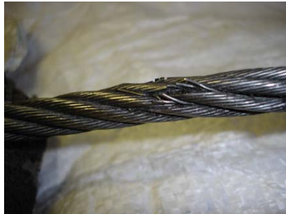
Bild 1: Typische Bruchstellen an einem Seilrutschen- oder einem Sicherheitsseil
