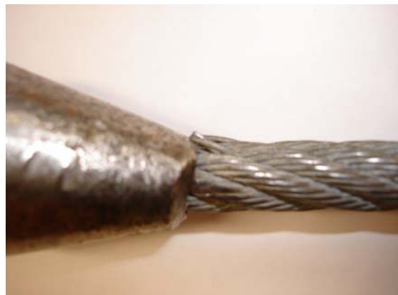
Bild 3: Beispiel eines Kabels das sich an einem Fixpunkt sowohl drehen als auch biegen kann
